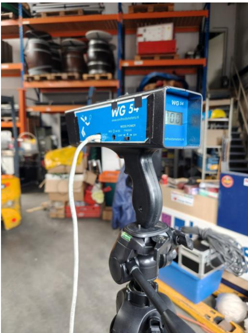
Afbeelding 5 - Triggerpistool/snelheidsmeter met aansluitingen.
