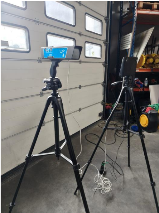
Afbeelding 2 - Plaats display en triggerpistool tegenover elkaar op de statieven.
