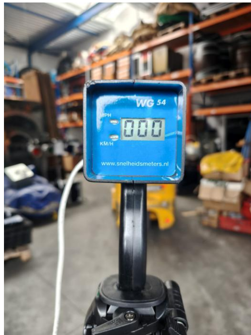
Afbeelding 6 - Controleer op het scherm of mph of km/h actief is.
