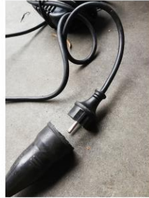
Stap 3, stop de stekker in het stopcontact LET OF: Als het apparaat het niet doet draai de stekker dan om. (Hij kan er maar op 1 manier in) Druk daarna op RESET.
