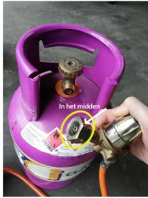
Stap 1, Verbind de slang met de gastank en zorg dat de moer in het midden zit.
