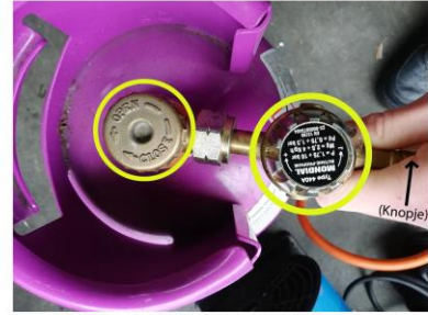
Stap 4, Draai de gaskraan open (Links). Daarnaast kan je ook de hoeveelheid gas regelen met de rechter knop. Als je de rechter knop open draait druk dan eerst even op het knopje aan de zijkant. (2 tot 3 seconden) Hoe verder je hem open draait hoe meer gas er uitkomt.
