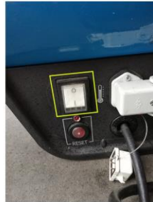
Stap 6, Als alles goed is aangesloten kan je de schakelaar aan zetten.
