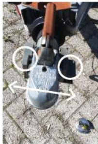
Stap 2: Verwijder het 2 delige slot en leg het op de grond.
