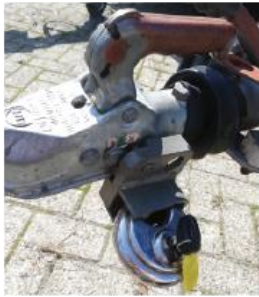
Stap 1: Verwijder het slotje met de sleutel en Leg hem neer.
