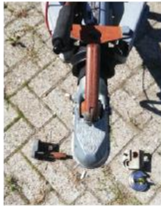
Stap 2: Verwijder het 2 delige slot en leg het op de grond.
