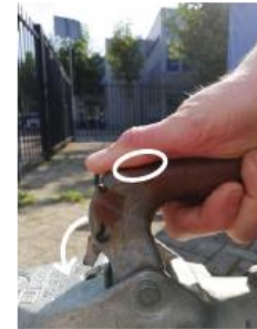
Stap 3: Duw het knopje in het midden van het handvat in, en duw het handvat naar boven zodat het pinnetje in het gaatje valt.
